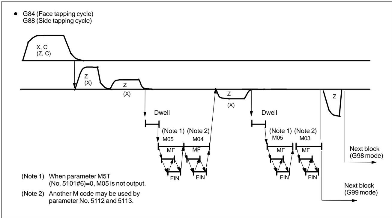
Fig 11.6 (d) Canned cycle for T series
